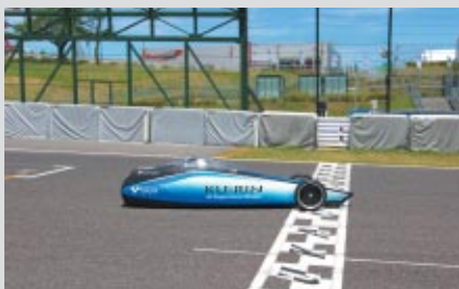
空気を動力源として走る豊田自動織機製「KU:RIN(クーリン)」
